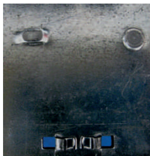
Trzy punkty łączenia: trapezoidalny, okrągły i perforowany
